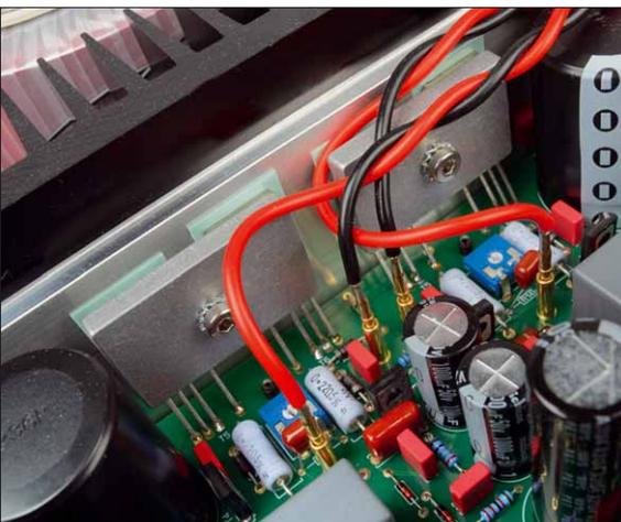
*Die Ausgangstransistoren sind erdbebensicher befestigt und effektiv gekühlt. Alles in diesem Verstärker ist durchdacht*
